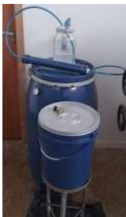
Figura 1 – Biodigestor completamente montado e abastecido
